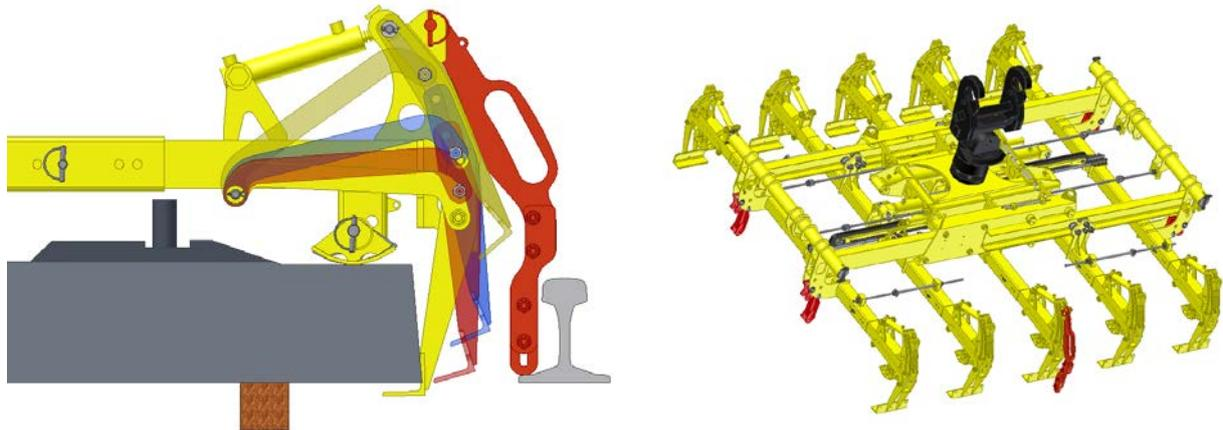
Die besonderen Vorteile dieses Verlegegerätes sind zum einen der geringe Platzbedarf beim Öffnen der 10 Greifarme, sowie zwei einstellbare Abstandbügel (rot), sodass die Lehrschiene als Anschlag verwendet werden kann.
