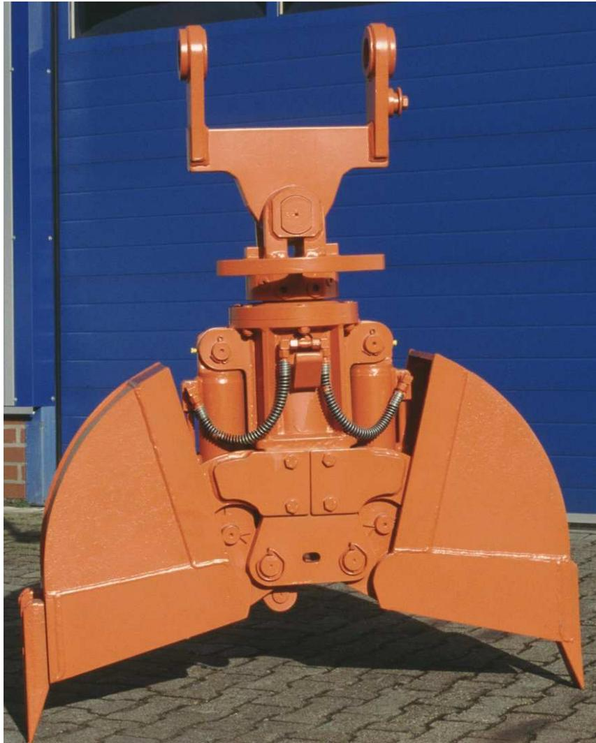
Der „**Schwellenfachgreifer 280**“ wurde speziell für den Gleisbau in einer extrem niedrige Bauform entwickelt, wodurch auch Arbeiten unter Fahrleitungen möglich sind.
