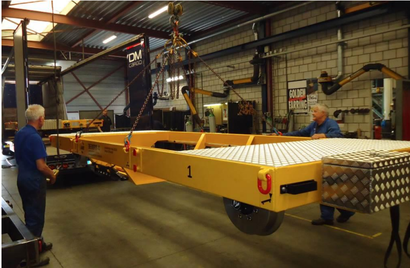
Heben des Anhängers mittels 4-Strang-Kettengehänge
