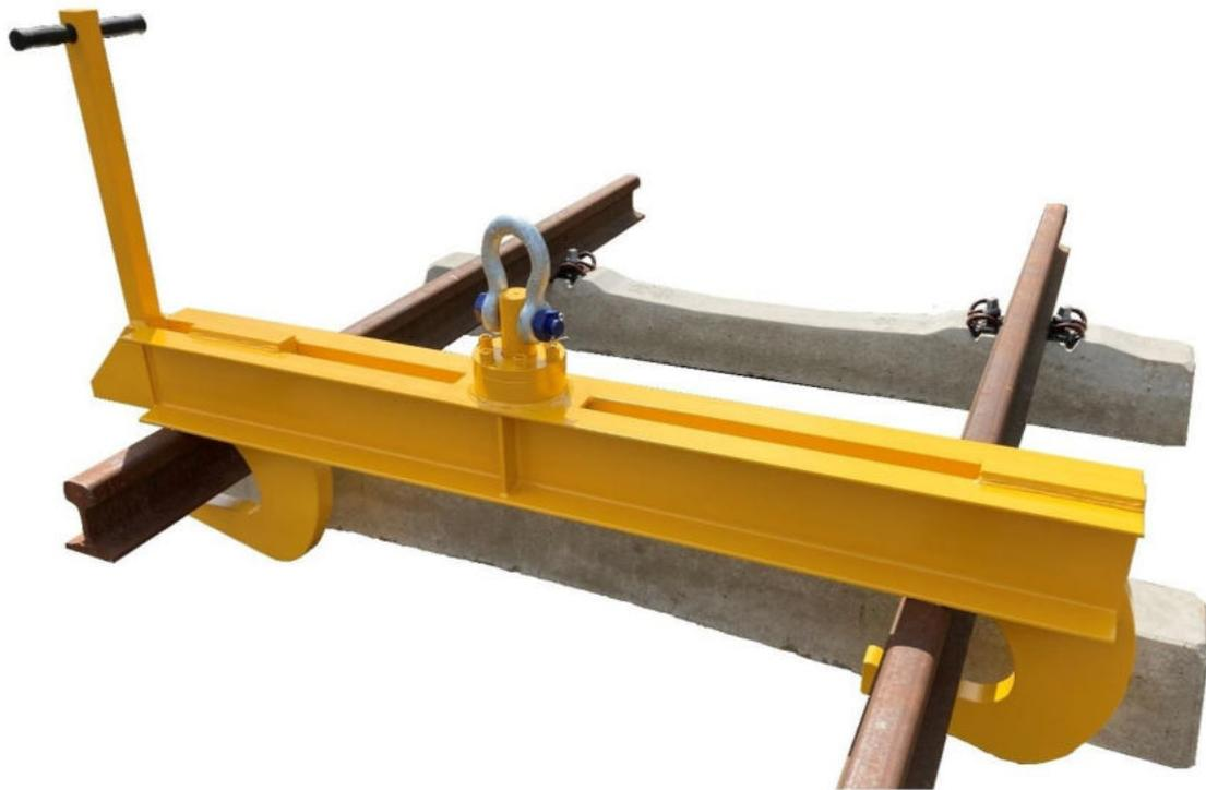
Einfache Traverse für Gleisjoche die ohne Hydraulik auskommt
