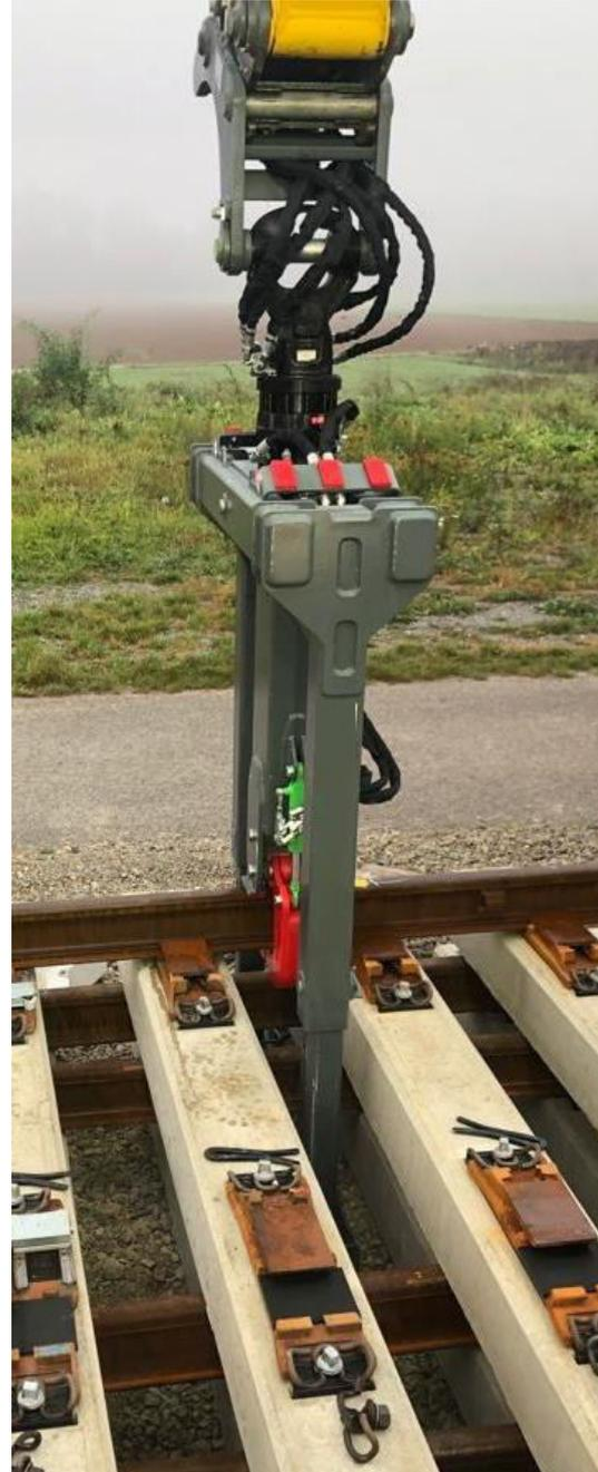
Durch den Weichensegmentheber können Weichensegmente bis zu 10 t mit dem Bagger als Trägergerät auch an einer Stielverlängerung gehoben werden. Durch das Gerät ist es möglich schneller, sicherer und schonender zu Arbeiten als es mit einer Gleishebewinde durchführbar wäre.
