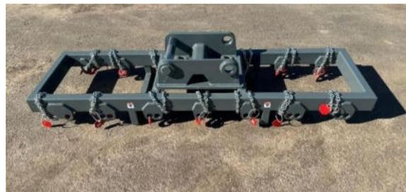
Schwellenkettentraverse mit SW33 Aufnahme zur Verwendung an einem Tiltrotator; mit ihr ist es möglich, die Schwellen in unebenem Gelände zum Beispiel an einer Böschung besser ablegen oder aufnehmen zu können.
