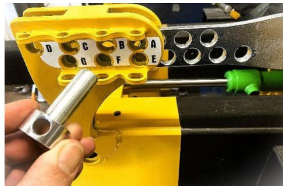
Die Kontaktflächen am Greifer sind mit einem sehr **verschleißfestem** Gummipad belegt.
